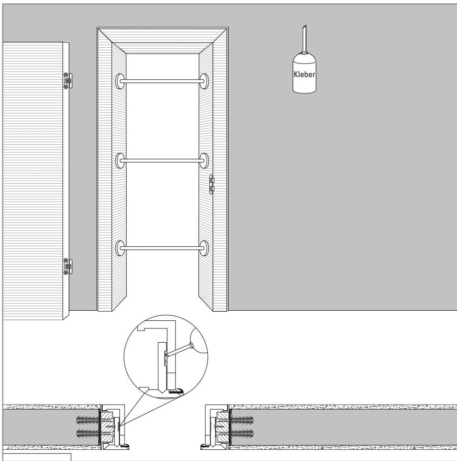
**(DE)** An den Streifen der Falzzarge geeigneten Kleber auftragen. Die Zierzarge in die Falzzarge einfügen und spreizen. Ab 160 mm Wandstärke eine Zierargenhinterfütterung vornehmen.
