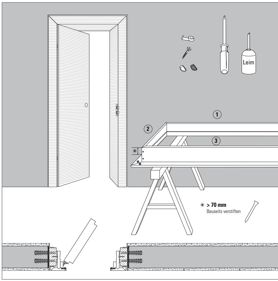
**DE** Zierteile kontrollieren, den Leim auf der Gehrung auftragen und zusammenlegen. Zierteile verbinden und mit Elepartverbindern fest schrauben.
