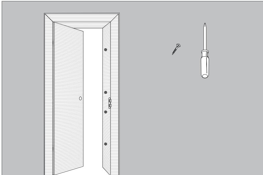
**DE** Nachdem die Bandseite mit der richtigen Falzluft eingestellt ist, wird das Falzteil montiert. Beide Teile druckfest hinterfüllen und mit geeigneten Schrauben am Blindstock befestigen.
