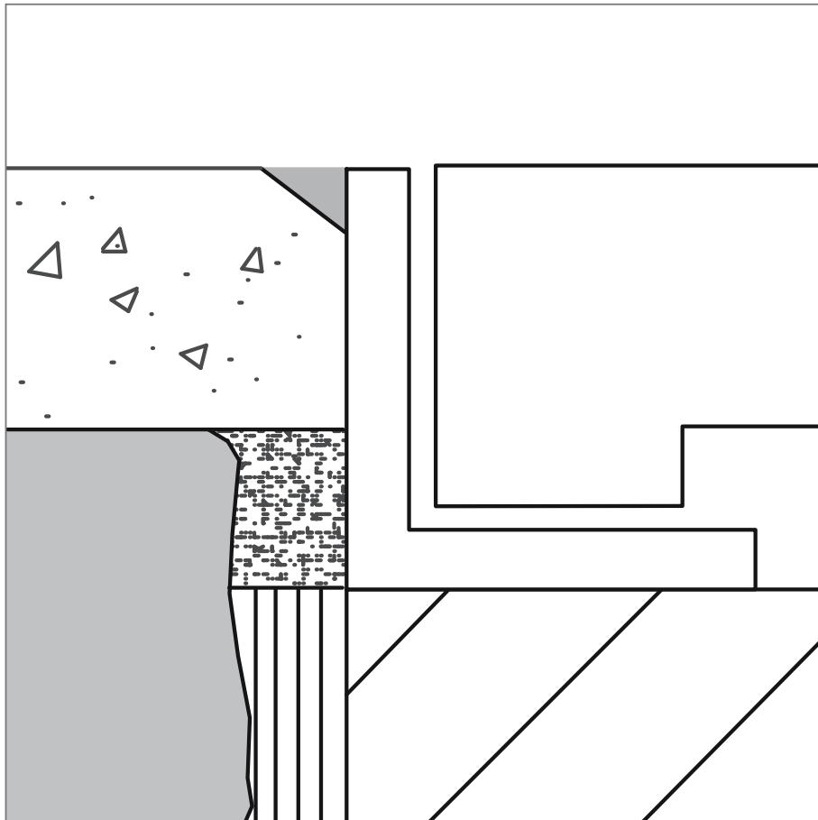
**(DE)** Zur Minimierung der Gefahr von Rissbildung zwischen Alu-Winkel und Wandabschluss empfehlen wir eine Acryl-Dehnungsfuge zwischen Alu-Winkel und Putz nachträglich einzubringen.
